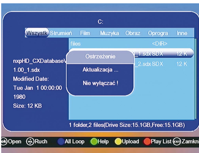
Wpisania listy znajdującej się na nośniku USB do odbiornika (na przykład po edycji) dokonuje się w menu Kontrola USB / Menu USB: należy najechać kursorem na wybraną listę i potwierdzić klawiszem OK. Rozpocznie się procedura przedstawiona na ekranie jako „Aktualizacja oprogramowania”, która trwa kilka-kilkanaście sekund. W trakcie jej trwania nie widać paska postępu, wyświetlany jest za to komunikat widoczny na załączonej ilustracji.
